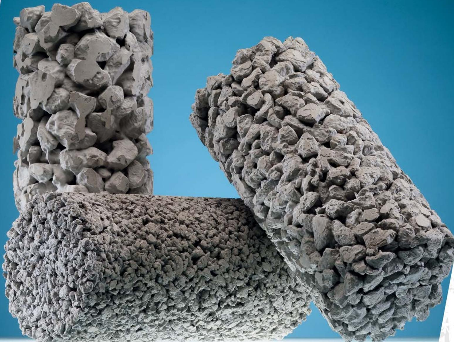
*İçeriğinde ince agregat bulunmayan, yalnızca iri agregat çimento ve belirlenen oranlarda suyun karıştırılmasıyla oluşan boşluklu ve geçirimli malzemedir.*
